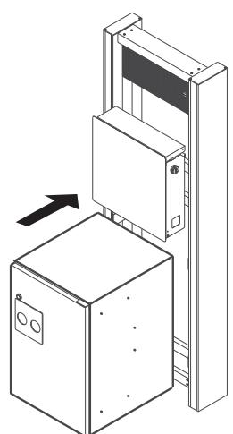
3. 打ち抜いた穴と支柱側のネジ穴部が重なるよう宅配ボックスの位置を調整してください。
