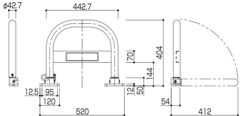
② 加工した穴位置に本体をあわせオールアンカーをたたき込み、ナットを締めてください。
