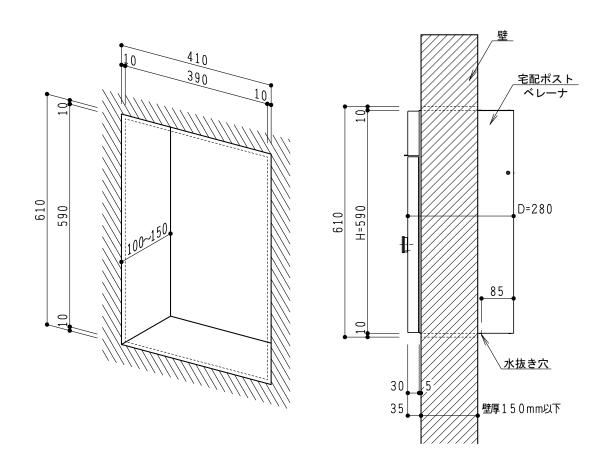
(1)壁面に取付ける為の穴を設けます。
